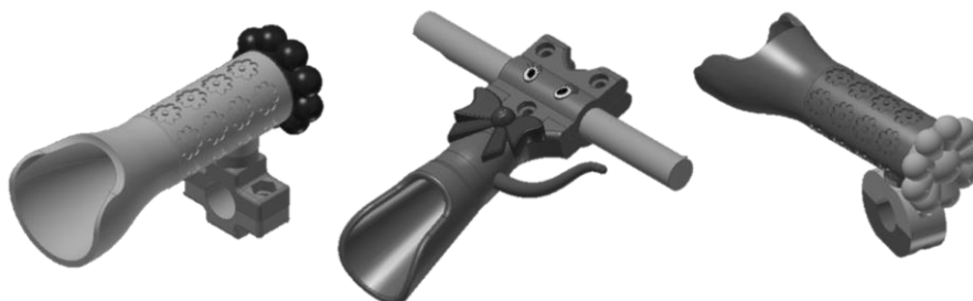
Ryc. 2. Przykładowe rozwiązania konstrukcyjne protezy adaptacyjnej wspomagającej jazdę na rowerze dziecka z wrodzonym ubytkiem ręki
