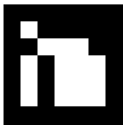
Ryc.2. Marker umożliwiający śledzenie obiektów na obrazie z kamery, źródło: [3]
