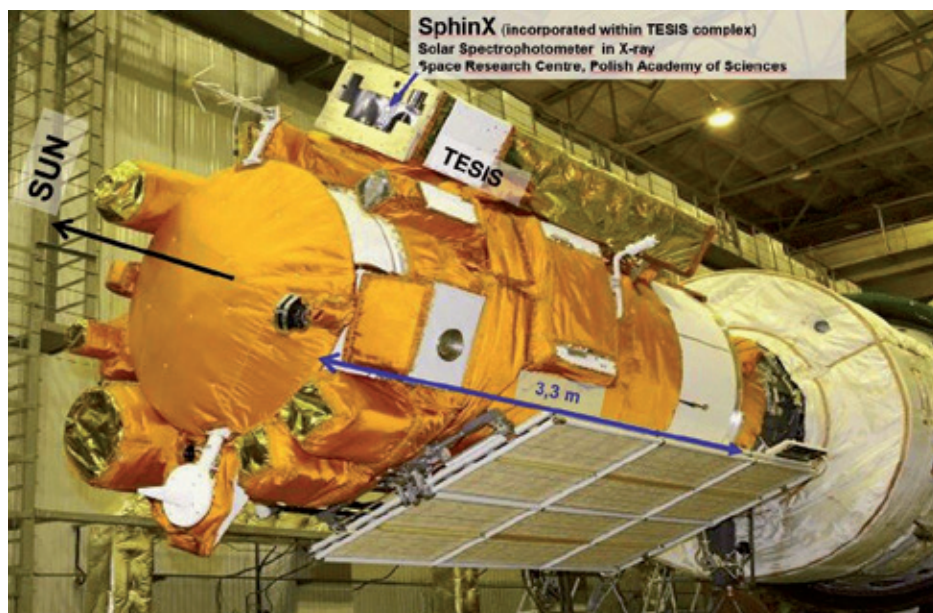
Spektrofotometr SphinX na pokładzie rosyjskiego satelity CORONAS-Photon podczas badań przedstartowych na kosmodromie w Plesiecku (Rosja)
