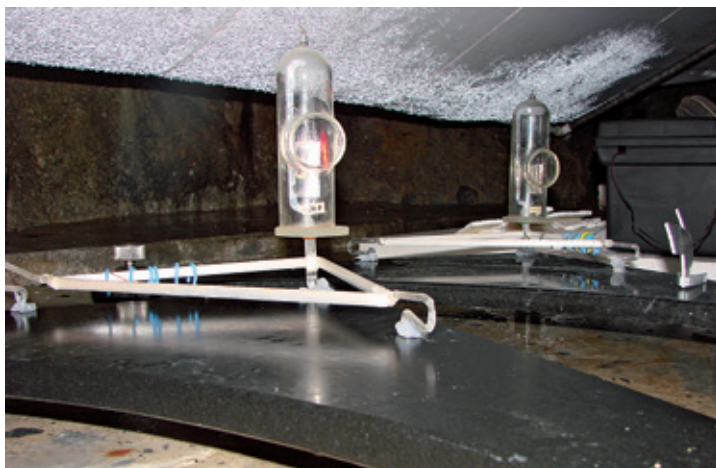
Kwarcowe wahadła horyzontalne na platformach pomiarowych
