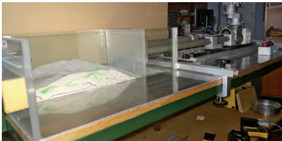
Urządzenie MAST-2 służące do modelowania analogowego struktur tektonicznych dla poznania mechanizmów deformacji skorupy ziemskiej
