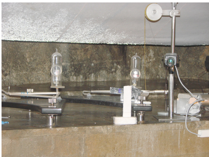
Wahadła horizontalne i kamera systemu rejestracji
