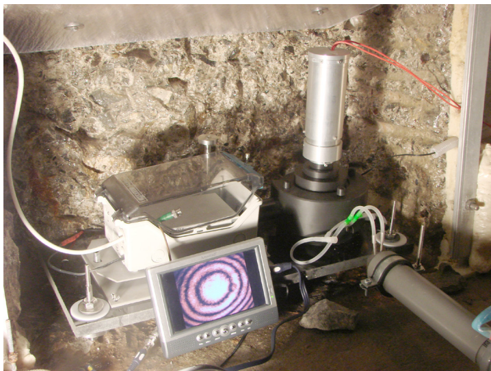
Miernik interferencyjny klinometru hydrostatycznego na stanowisku pomiarowym
