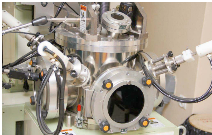
Piec łukowy do wytwarzania monokrystalów metodą Czochralskiego
