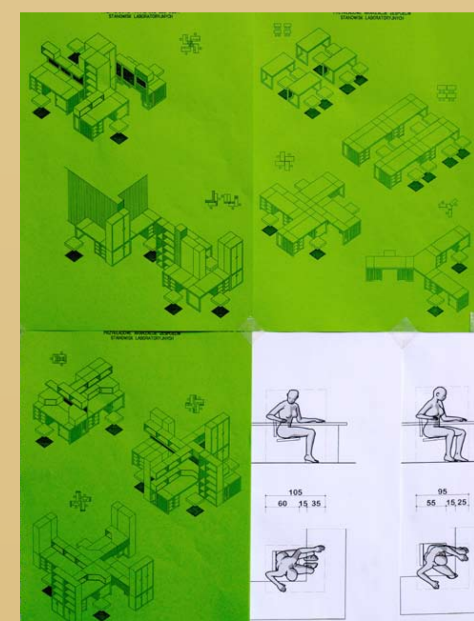
Fot. 4. Projekt systemu mebli laboratoryjnych wraz z analizą zróżnicowanych zestawień funkcjonalnych i wymagań przestrzennych użytkowników.
